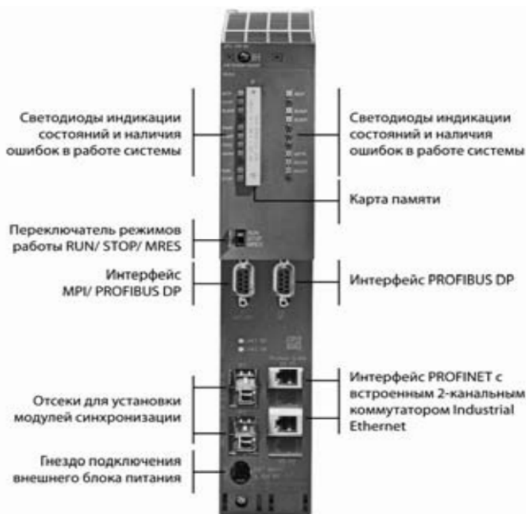
Рисунок 9. ЦПУ контроллера СК-4000Р
